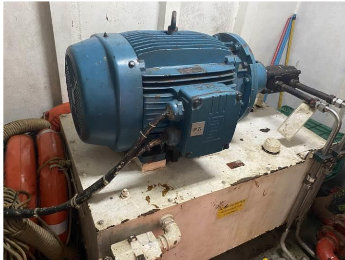
Unidade hidráulica para guincho auxiliar de convés.
